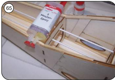
65 Klebestellen in den Spanten mit Epoxy verkleben.
