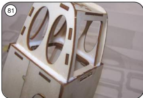
Satt mit Holzleim vermuffen.
