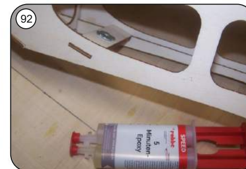
89 Zm Einbau der Einschlagmutter für die Tragflächenverschraubung diese mit einer passenden Gewindeschraube (M6) und Unterlegscheiben in den Holzsteg R16/R17 einziehen und von der Unterseite mit Epoxy sichern.
