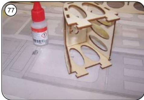
Bauteile für den Motorträger mit Sekundenkleber zusammenkleben und anschließend mit Holzleim vermuffen.
