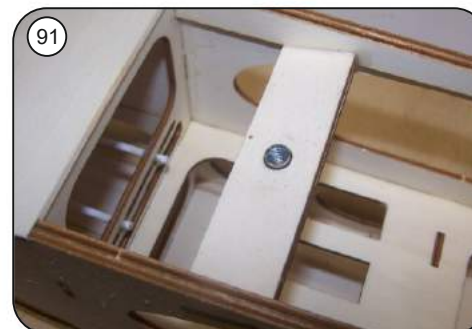
89 Zm Einbau der Einschlagmutter für die Tragflächenverschraubung diese mit einer passenden Gewindeschraube (M6) und Unterlegscheiben in den Holzsteg R16/R17 einziehen und von der Unterseite mit Epoxy sichern.
