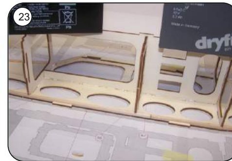
22 Klebeflächen satt mit Holzleim einstreichen, Spantengerüst einsetzen und bis zum Durchtrocknen mit Gewichten verpressen.
