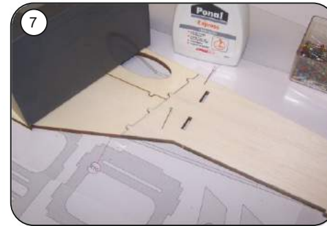
7 Hinteres Rumpfsenteil R3 zusammen R1-R2 auf dem Plan ausrichten und verkleben.
