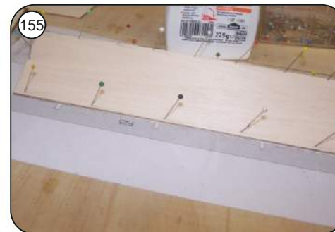
154 Obere Beplankung F26 mit reichlich Holzleim aufkleben und bis zum Durchtrocknen mit Nadeln sichern.
