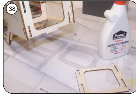
38 Kopfspantenaufdoppelung R18 ankleben, herausgequollenen Leim in den Schlitz für den Motorträger entfernen.
