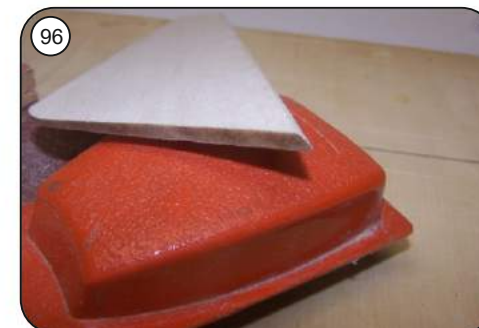
96 Seitenruder S3 gem Bauplan ins Profil verschleifen und Scharnieranschlag schräg anschleifen.
