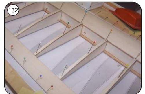
131 Rippenaufleimer auf der Tragflächenoberseite einpassen und aufleimen.
