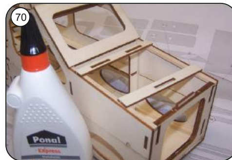
70 Beplankungsstreifen im Akkudeckelbereich R27 und R31 aufkleben, dabei den Akkudeckel R30 zum Ausrichten verwenden.
