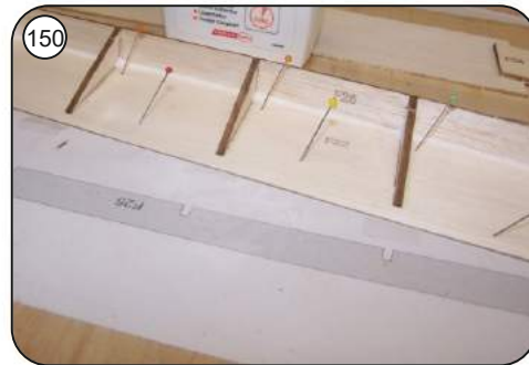
150 Klebekante F22 zu F25 mit Holzleim vermuffen.
