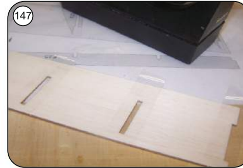
147 Steckungsslitze für die Rippensegmente von der Unterseite mit Tesafilm abkleben.
