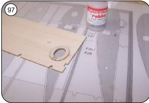
97 Verstärkungsring für Kabeldurchführung F2 auf untere Nasenbeplankung F1 aufkleben.
