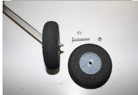
Teile für einen Fahrwerksschenkel, 1 Alu-Fahrwerksarm, 1 weisse Verkleidung, 1 Radachse Schraube M4x30mm, 1 Mutter M4, 1 Stopmmutter M4, 3 Einschlagmuttern, 3 Zylinderschrauben M3x 16mm
