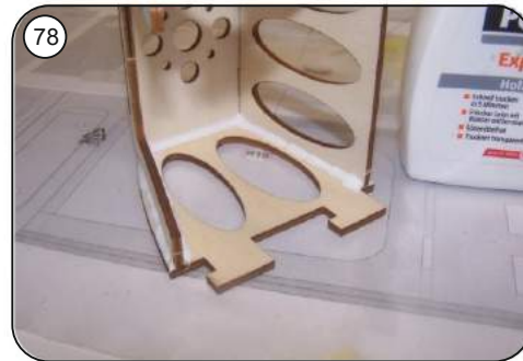
Bauteile für den Motorträger mit Sekundenkleber zusammenkleben und anschließend mit Holzleim vermuffen.
