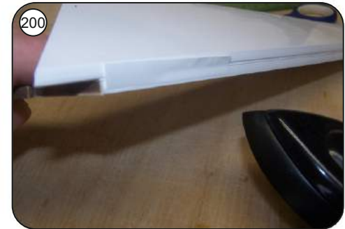
197 Zum Anscharnieren des Seitenruders einen etwa 15mm breiten Folienstreifen hälftig auf die Anschlagkante des Leitwerks aufbügeln, das Seitenruder entsprechend dem späteren Ruderausschlag abgewinkelt anbügeln. Seitenruder kompl. aufklappen und oben und unten jeweils einen Streifen Folie zur Verstärkung in die Scharnierkehle einbügeln. Diese Vorgehensweise gilt auch für das Höhenruder und die Querruder.
