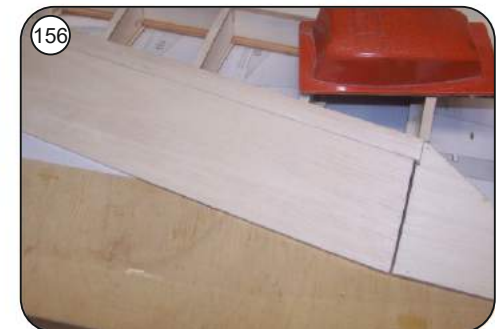
156 Querruder in die Tragflächen einpassen, evtl. etwas nachschleifen.
