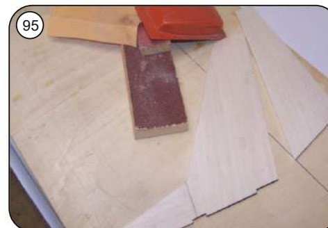
95 Seitenleitwerk sauber verschleifen dabei die Vorderkanten verrunden (s. Bauplan).
