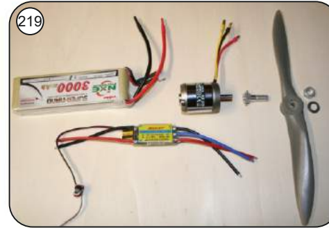
219 Antriebskomponenten, Akku, Regler und Motor konfektionieren ( Stecker u. Buchsen anlöten )
