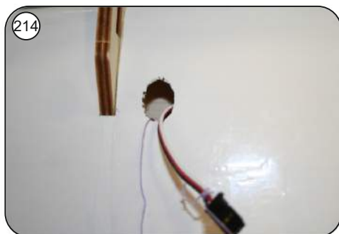
Den Zwirn mit einem Drahthaken durch die Durchführungsöffnung herausziehen und das Verlängerungskabel durchziehen.
