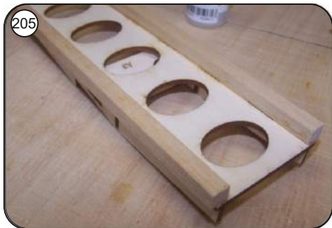
Leisten an beiden Seiten aufkleben, die Akkurutsche Probeweise in den Rumpf einsetzen und später nach Fahrwerksmontage auf der Fahrwerksplatte verschrauben, wahlweise auch einkleben.
