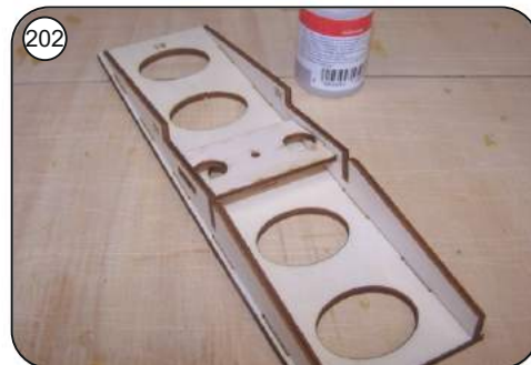
201 Aus den Bauteilen A1, A2 und A3 die Akkuauflage zusammenkleben, die Bauteilbezeichnung auf A1 ist hinten.
