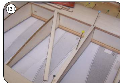
131 Rippenaufleimer auf der Tragflächenoberseite einpassen und aufleimen.
