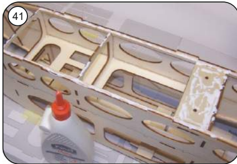
41 Klebeflächen für den Rumpfboden nur bis Spant R6 satt mit Holzleim einstreichen.
