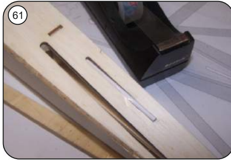
61 Rumpfaustritte der Bowdenzugrohre von der Aussenseite am Rumpf mit Tesafilm abkleben und Bowdenzugrohre von der Innenseite mit Epoxy verkleben.
