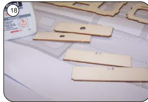
18 Tragflächenhalterung R15-R16 sowie Mutternlager R17-R18 bündig aufeinander leimen und bis zum Durchtrocknen verpressen.
