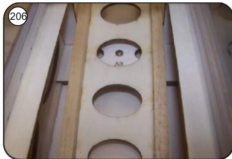
Leisten an beiden Seiten aufkleben, die Akkurutsche Probeweise in den Rumpf einsetzen und später nach Fahrwerksmontage auf der Fahrwerksplatte verschrauben, wahlweise auch einkleben.
