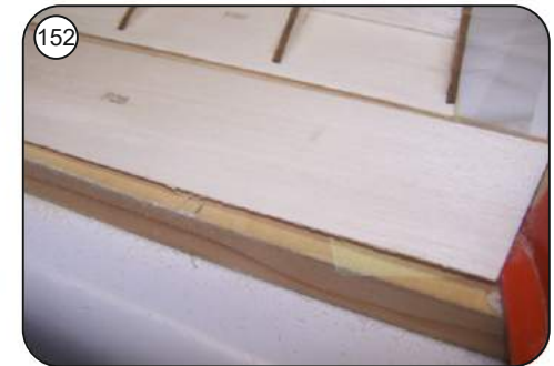
152 Hinterkante von oberer Beplankung F26 schräg anschleifen.
