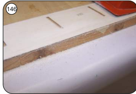
146 Hinterkante der unteren Querruderbepl. ( F22 ) schräg anschleifen.
