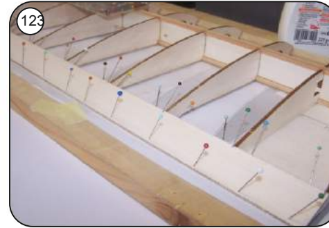
122 Endleistenbeplankung F18 mit reichlich Holzleim aufkleben und bis zum Durchtrocknen mit Nadeln sichern.
