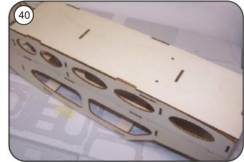
40 Vorderen Rumpfboden R19 ohne Leim aufsetzen und anpassen.
