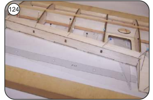
124 Endleistenbeplankung F20 aufkleben und bis zum Durchtrocknen mit Nadeln sichern.
