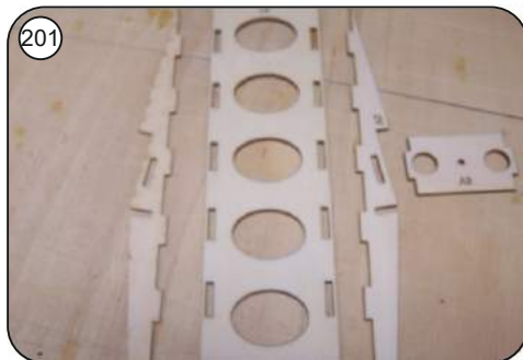
201 Aus den Bauteilen A1, A2 und A3 die Akkuauflage zusammenkleben, die Bauteilbezeichnung auf A1 ist hinten.
