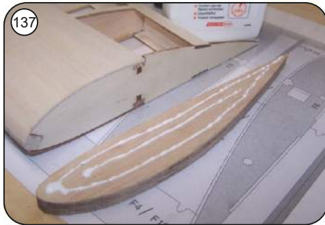
137 Rippenblock 2x F16 mit reichlich Holzleim passgenau auf die Endrippe F15 aufkleben.
