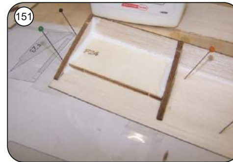
151 Verstärkung für Ruderhorn F24 einkleben.
