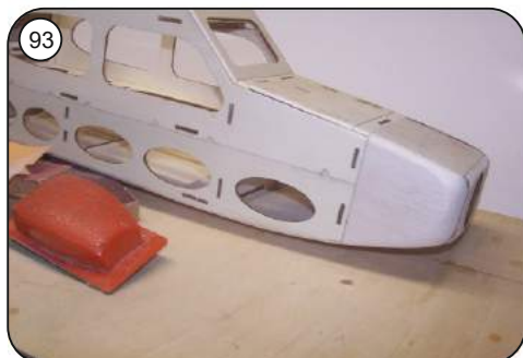
93 Gersanten Rumpf sauber verschleifen, dabei die Kanten verrunden.
