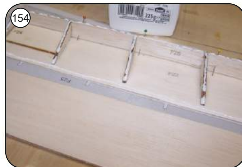
154 Obere Beplankung F26 mit reichlich Holzleim aufkleben und bis zum Durchtrocknen mit Nadeln sichern.
