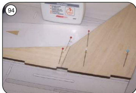
94 Seitenleitwerksteile S1 und S2 gemäß Bauplan verkleben.
