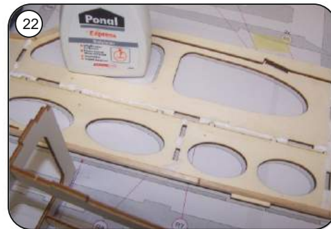
22 Klebeflächen satt mit Holzleim einstreichen, Spantengerüst einsetzen und bis zum Durchtrocknen mit Gewichten verpressen.
