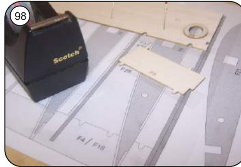
98 Alle Stossverklebungen der Beplankungsteile für eine saubere Oberfläche von der Unterseite mit Tesafilm abkleben.
