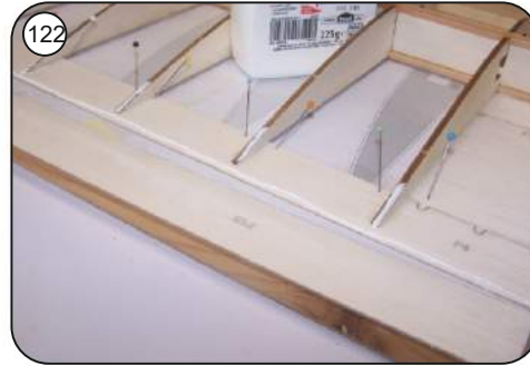
122 Endleistenbeplankung F18 mit reichlich Holzleim aufkleben und bis zum Durchtrocknen mit Nadeln sichern.
