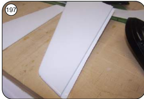
197 Zum Anscharnieren des Seitenruders einen etwa 15mm breiten Folienstreifen hälftig auf die Anschlagkante des Leitwerks aufbügeln, das Seitenruder entsprechend dem späteren Ruderausschlag abgewinkelt anbügeln. Seitenruder kompl. aufklappen und oben und unten jeweils einen Streifen Folie zur Verstärkung in die Scharnierkehle einbügeln. Diese Vorgehensweise gilt auch für das Höhenruder und die Querruder.
