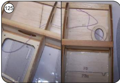
125 Zum nachträglichen Durchziehen der Servokabel Haushaltswirrn in die Fläche einziehen.
