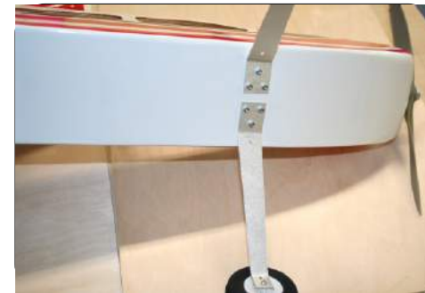
Fahrwerk komplett montiert
