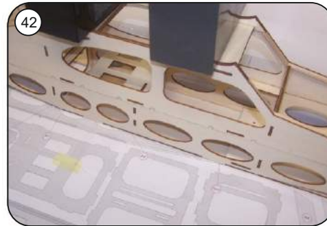
42 Rumpfboden auf das Baubrett legen und das Rumpferüst aufsetzen, mit Gewichten bis zum Durchtrocknen fixieren.
