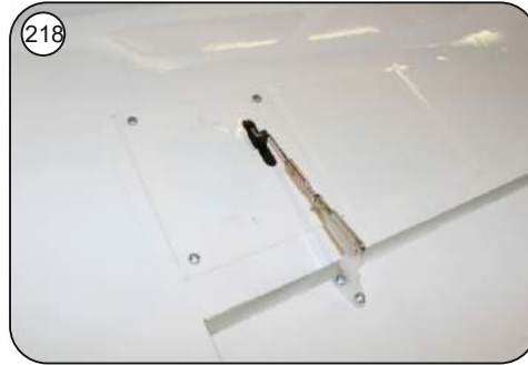
218 Ruderhorn anschrauben, Querruderanlenkung aus Z-Gestänge, Löthülse und Gabelkopf herstellen und einbauen.
