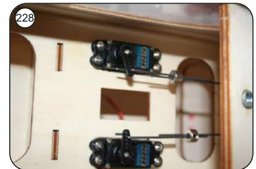
227 Z-Gestänge für die Servoanschlüsse herstellen, in die Servoarme einhängen und mit Stellringen mit den Ruderanlenkungen verbinden. Bowdenzugrohr im Spantendurchgang mit Epoxy sichern.
