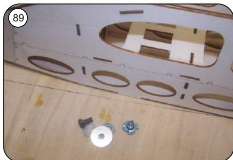
89 Zm Einbau der Einschlagmutter für die Tragflächenverschraubung diese mit einer passenden Gewindeschraube (M6) und Unterlegscheiben in den Holzsteg R16/R17 einziehen und von der Unterseite mit Epoxy sichern.
