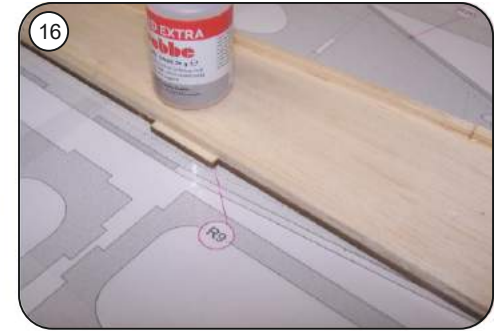
14 Auf das gesamte Rumpfteil an der Ober- und Unterkante mit Balsaleisten 4 x 4 mm an der Aussenkontur bündig aufkleben.
