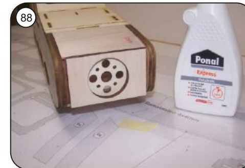
88 Nasenfüllklotz R37 an den Rumpfkopf ankleben.
