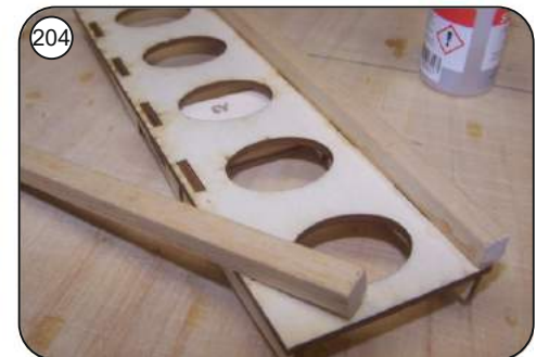
204 Aus Reststücken der Nasenleiste (8x8mm) die Seitenführungen ablängen und aussen bündig aufkleben.
