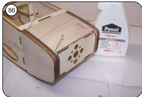
85 Obere Beplankung für Motorträger R38 und untere Beplankung für Motorträger R38u einpassen und mit Holzleim einkleben.
