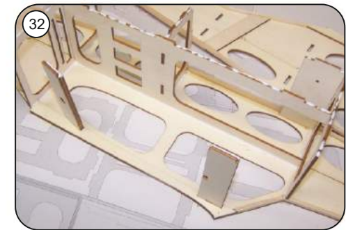
Klebestellen am Spantengerüst satt mit Holzleim einstreichen.
