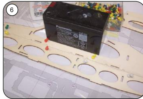
6 R1 und R2 mit Holzleim zusammenkleben und bis zum Durchrocknen mit Stossnadeln und Gewichten fixieren.
