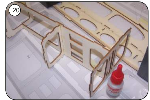
20 Spantengerüst R6, R7, R8 und R9 mit Sekundenkleber zusammenheften.
