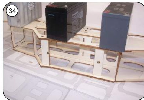
Rumpfteilwand aufstecken und bis zum Durchtrocknen mit Gewichten belegen.
