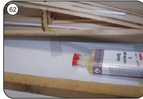
61 Rumpfaustritte der Bowdenzugrohre von der Aussenseite am Rumpf mit Tesafilm abkleben und Bowdenzugrohre von der Innenseite mit Epoxy verkleben.
