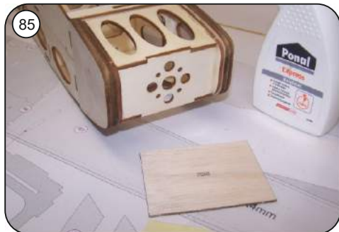
85 Obere Beplankung für Motorträger R38 und untere Beplankung für Motorträger R38u einpassen und mit Holzleim einkleben.
