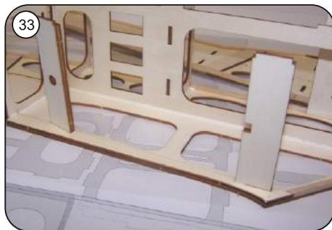
R14-15 und R16-17 im gleichen Arbeitsgang wie Bild 32 einkleben.
