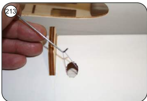
Den Zwirn mit einem Drahthaken durch die Durchführungsöffnung herausziehen und das Verlängerungskabel durchziehen.
