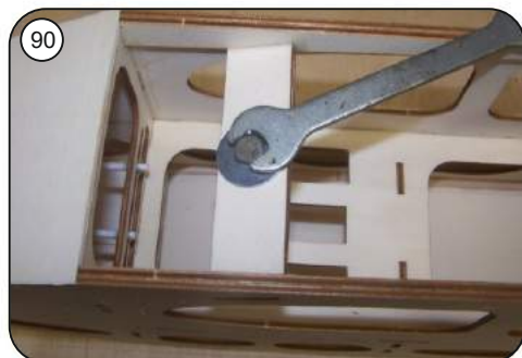
89 Zm Einbau der Einschlagmutter für die Tragflächenverschraubung diese mit einer passenden Gewindeschraube (M6) und Unterlegscheiben in den Holzsteg R16/R17 einziehen und von der Unterseite mit Epoxy sichern.
