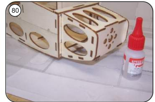
Fertigen Motorträger an den Rumpfkopf anpassen, Einsteckschlitz evtl. dabei etwas ausfeilen. Motorträger einhaken und an den Einsteckhaken mit Sekundenkleber sichern.
