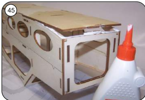
45 Holzleim in den zu verklebenden Bereich einbringen.
