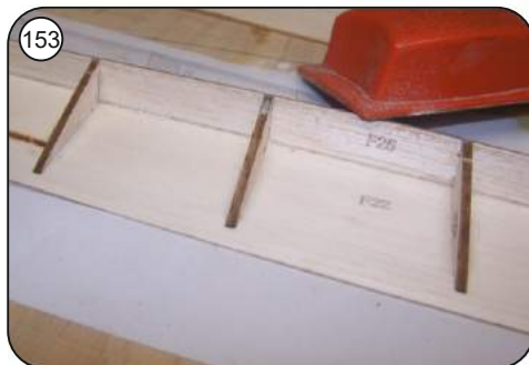
153 Anschlagleiste F25 an der Oberkante im Profilverlauf leicht anschleifen.
