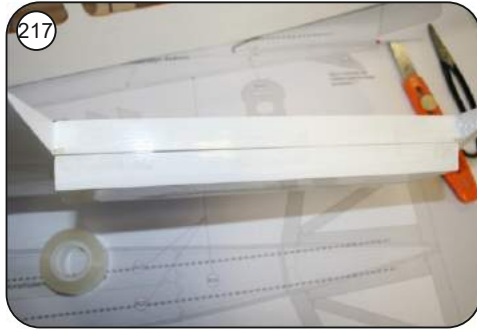
217 Querruder aufklappen und von der Innenseite mit zusätzlichen Klebestreifen sichern.
