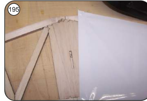
193 Bespannfolie nach den Markierungen zuschneiden und beim Aufbügeln die Folie etwa 1mm über die angezeichnete Kontur aufbringen.
