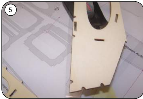
5 Die Klebekante von R1 zu R2 auf der späteren Rumpfaussenseite mit einem Tesastreifen abkleben.
