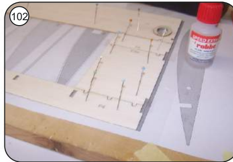
102 Beplankung F4 nach Plan einpassen und mit F3a verkleben.
