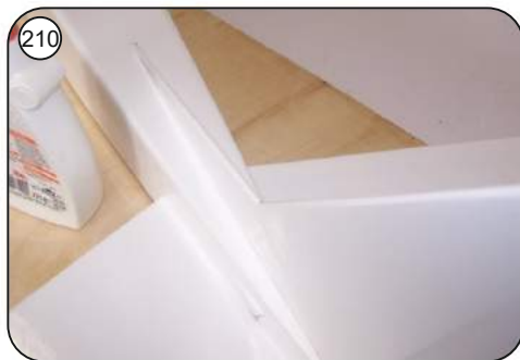
Seitenleitwerk rechtwinklig ausrichten und ebenfalls einkleben.
