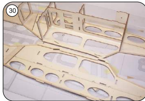
2. Rumpfteilteil ( Gegenseite ) mit Balsaleisten und Aufdoppelung R5 bestücken, probeweise ohne Leim auf das Spantengerüst anstecken.
