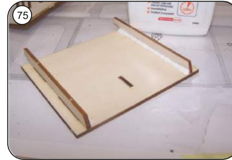
Steg R29 mit Sekundenkleber in den Akkudeckel R30 einkleben, nachträglich nur von der Innenseite mit Holzleim vermuffen.
