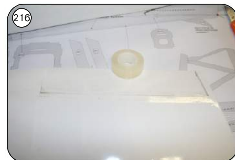
Querruder in die Tragfläche einsetzen und auf der Oberseite mit Scharnierklebeband ankleben.
