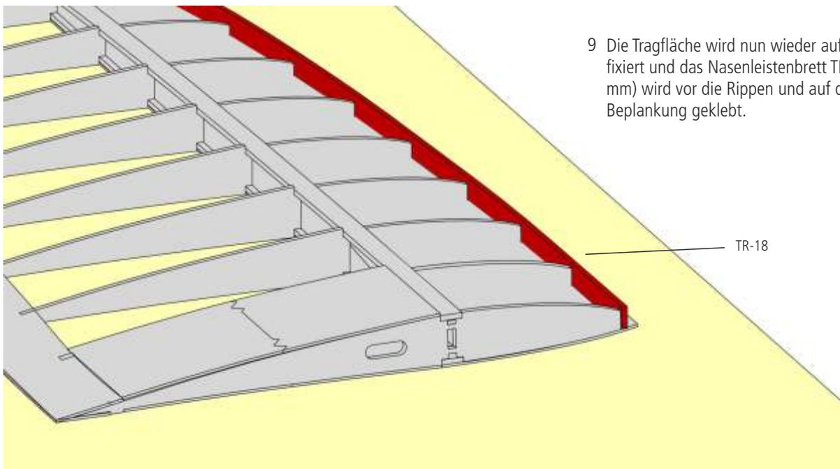
9 Die Tragfläche wird nun wieder auf dem Baubrett fixiert und das Nasenleistenbrett TR-18 (Balsa 2 x 8 mm) wird vor die Rippen und auf die untere Beplankung geklebt.
