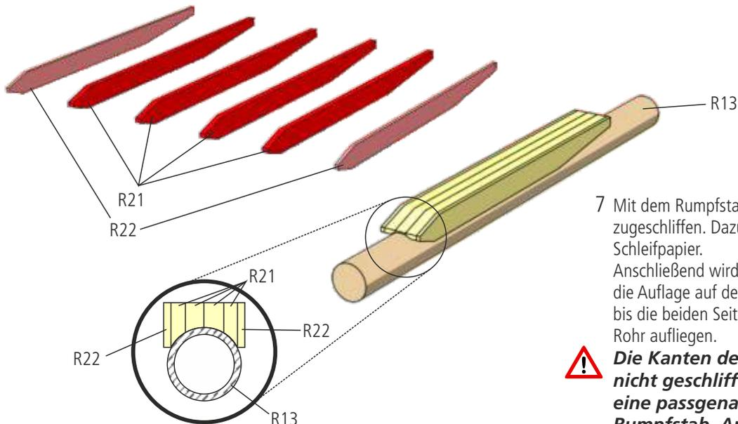
7 Mit dem Rumpfstabes R13 wird die Auflage passend zugeschliffen. Dazu umfassen Sie das Kohlerohr mit Schleifpapier. Anschließend wird mit dem runden „Schleifklotz“ die Auflage auf der Unterseite so weit geschliffen, bis die beiden Seitenteile aus Sperrholz frei auf dem Rohr aufliegen.
