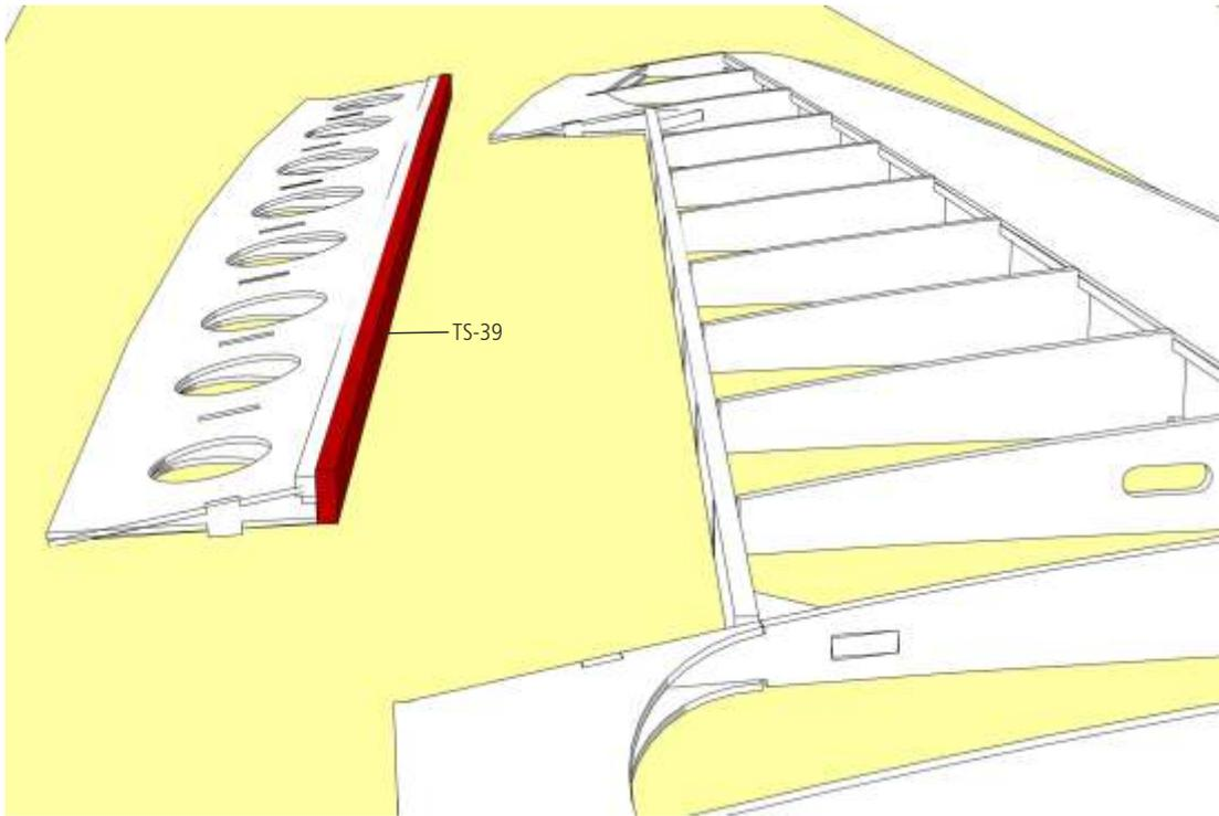
19 Mit einer feinen Säge wird das Querruder aus der Tragfläche getrennt. Die noch überstehenden Reste der Rippen werden plangeschliffen. An das Querruderblatt wird der Aufdoppler TS-39 geklebt und nach unten schräg geschliffen. Nach dem Finish der Tragfläche werden die Querruder auf der Oberseite mit einem Klebebandscharnier angeschlagen.
