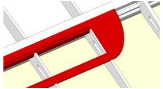
Die Leisten sowie die erste und die letzte Rippe im Klappenausschnitt stehen nach innen ein wenig über die Beplankung über. Dieser Überstand dient zur Auflage der Bremsklappe.
