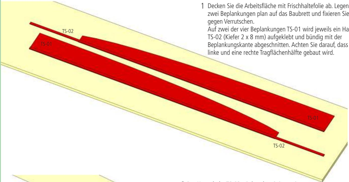
1 Decken Sie die Arbeitsfläche mit Frischhaltefolie ab. Legen Sie die zwei Beplankungen plan auf das Baubrett und fixieren Sie die Teile gegen Verrutschen.
