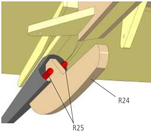
11 Die Bowzugrohre R25 werden jetzt durch das Kohlerohr geschoben, eins rechts und eins links am Sporn R24 vorbei. Verkleben Sie die Bowzugrohre am Sporn.
