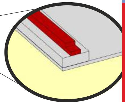
3 Die Tragfläche wird in den nächsten Schritten in einer Depron-Helling aufgebaut, um eine rechtwinklige Anordnung der Teile sicherzustellen. Legen Sie die Depron-Helling flach auf das Baubrett und fixieren Sie sie mit Klebeband. Legen Sie die Beplankung TM-01 und die Endleistenbeplankung TM-06 wie dargestellt in die Helling ein.
