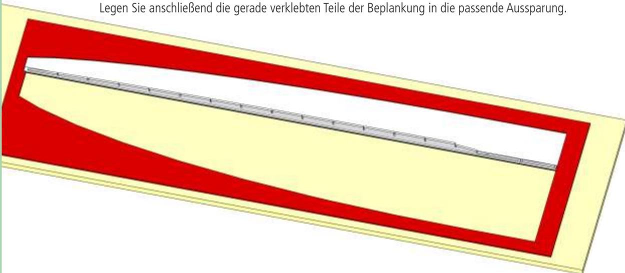
4 Legen Sie die zweiteilige Endleistenbeplankung TS-05 und TS-07 sowie die Querruderbeplankung TS-06 bereit und legen Sie diese locker in die Helling am hinteren Rand ein.
