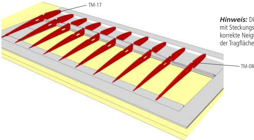
**Hinweis:** Die Rippe TM-07 wird erst später gemeinsam mit Steckenteil TM-05 eingeklebt. Durch TM-05 wird die korrekte Neigung der Rippe entsprechend der V-Form der Tragfläche festgelegt.
