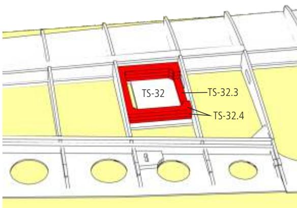
Verkleben Sie nun die Servorahmen TS-32.3 und TS-32.4 wie in der Abbildung gezeigt miteinander. Der fertige Servokasten wird dann seitlich an die Rippen und an den Holm geklebt. Achten Sie dabei auf die Kabeldurchführung für das Servo, je nach linker oder rechter Tragfläche. **Achtung: Nicht mit dem Servobrett TS-32 verkleben!** Dies dient nur als Auflage.
