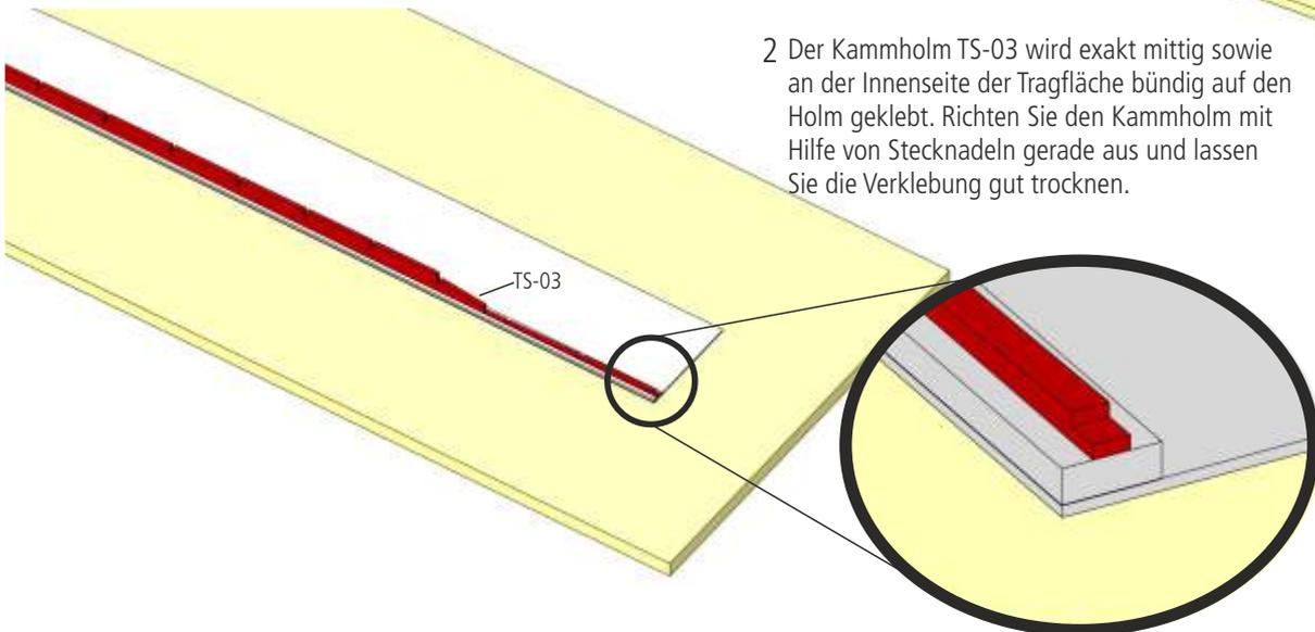
2 Der Kammholm TS-03 wird exakt mittig sowie an der Innenseite der Tragfläche bündig auf den Holm geklebt. Richten Sie den Kammholm mit Hilfe von Stecknadeln gerade aus und lassen Sie die Verklebung gut trocknen.
