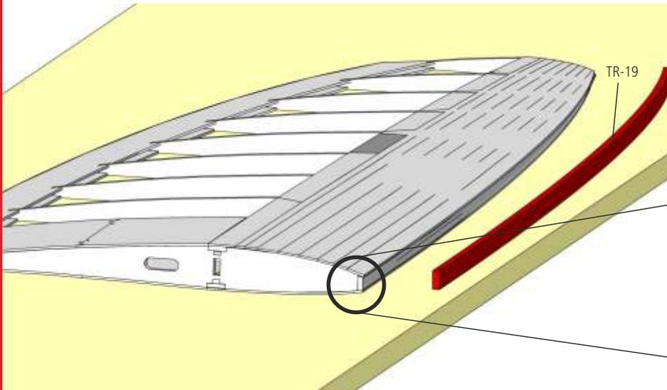
11 Das Nasenleistenbrett wird über die ganze Länge mit den Beplankungen plan geschliffen. Benutzen Sie dazu eine lange Schleifplatte. Anschließend wird die Nasenleiste TR-19 (Balsa 3 x 8 mm) vollflächig aufgeklebt und der Profilform entsprechend geschliffen.
