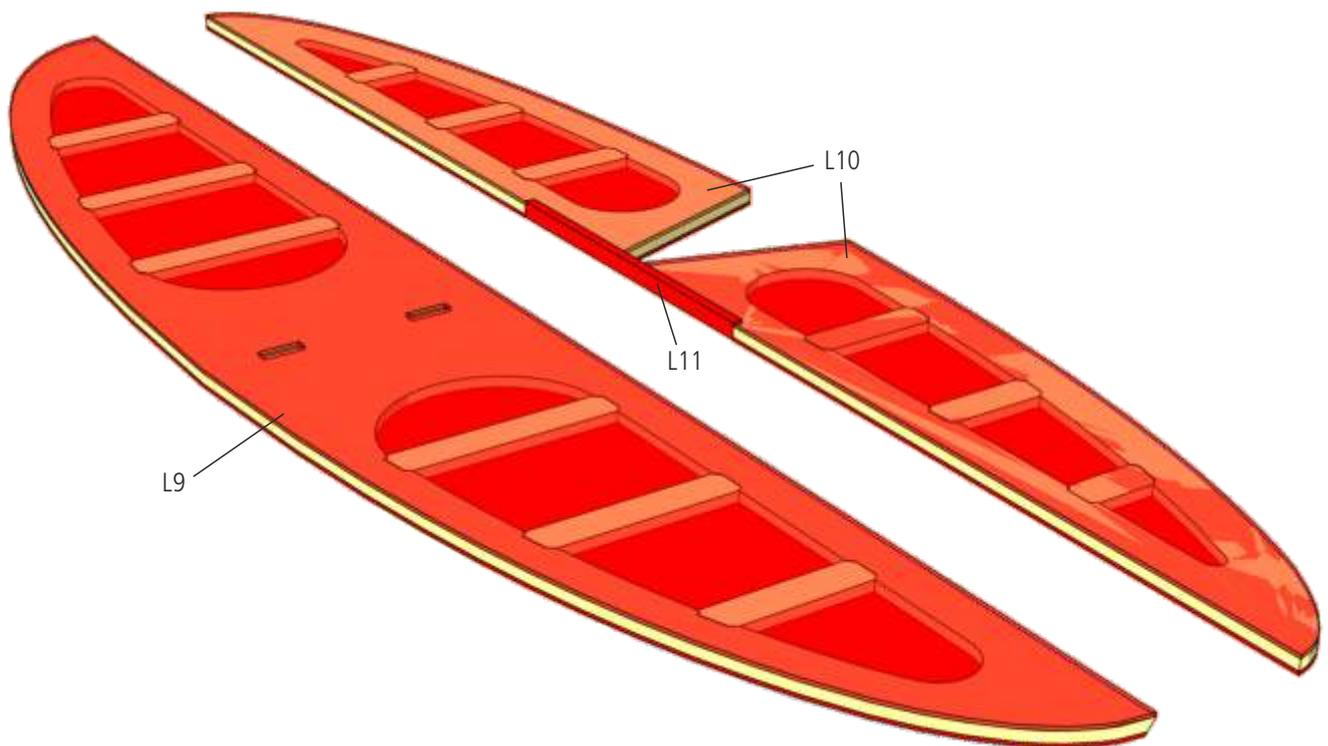
3 Nachdem die Beplankung gut getrocknet ist, schleifen Sie die Höhenruderdämpfungsfäche an der Hinterkante schräg an, damit das Ruder später in beide Richtungen sauber ausschlagen kann.
