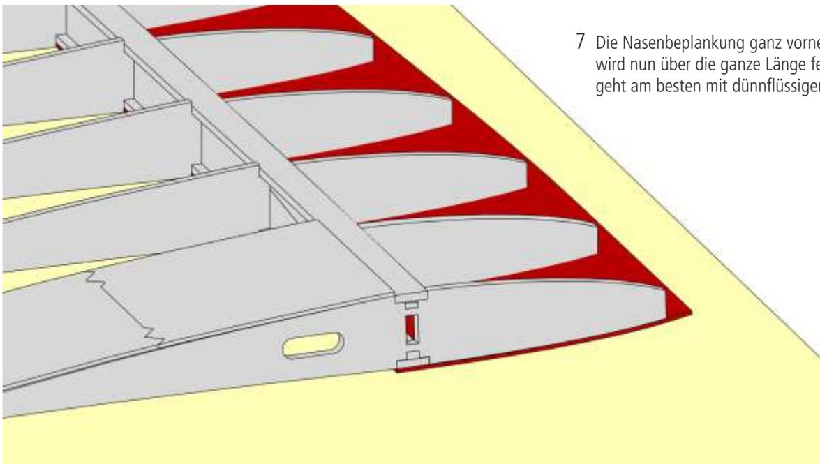
7 Die Nasenbeplankung ganz vorne unter den Rippen wird nun über die ganze Länge fertig angeklebt. Dies geht am besten mit dünnflüssigem Sekundenkleber.
