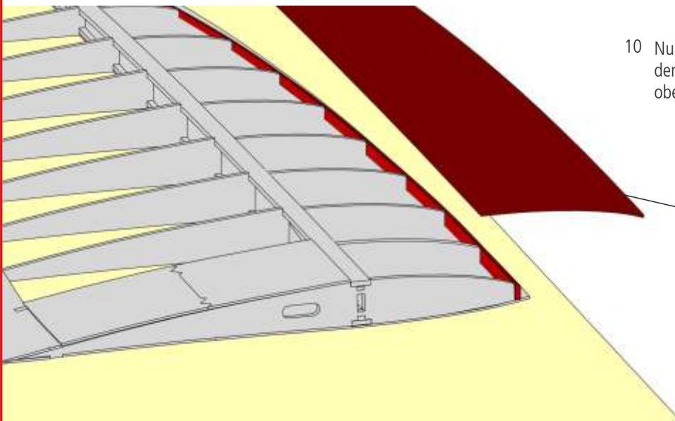
10 Nun wird das Nasenleistenbrett mit den Oberkanten der Rippen bündig geschliffen und anschließend die obere Beplankung TR-01 aufgeklebt.
