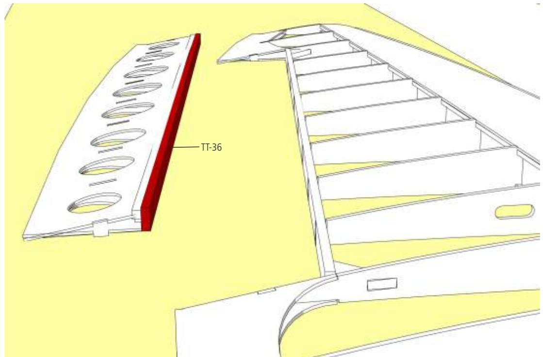
**Tipp:** Wollen Sie kein Klebebandscharnier, können sie die Aufdopplerleiste TT-36 auch von der Mittellinie aus nach oben und unten jeweils konisch schleifen und kleine Scharniere einsetzen.
