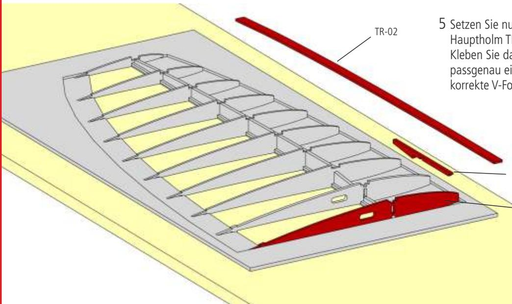
5 Setzen Sie nun das Steckungsteil TR-04 sowie den oberen Hauptholm TR-02 (Kiefer 2 x 8 mm) ein. Kleben Sie dann auch die Rippe TR-06 sauber und passgenau ein, dadurch ergibt sich automatisch die korrekte V-Form.
