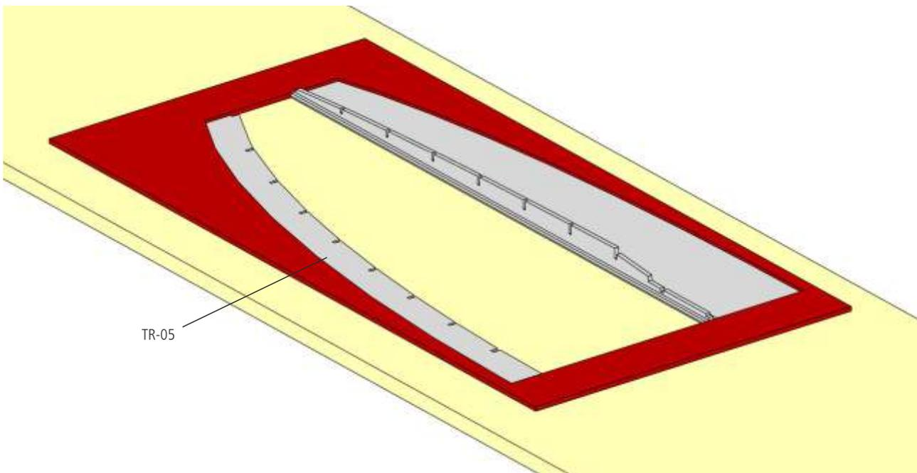
4 Setzen Sie die Tragflächenrippen TR-07 bis TR-15 wie dargestellt in den Kammholm ein. Die Rippen werden durch die Aussparungen in Holm und Endleiste exakt rechtwinklig zum Hauptholm ausgerichtet. Verklebt werden die Rippen zu diesem Zeitpunkt nur direkt am Holm, im Kammholm sowie in der Endleiste TR-05. Die Rippenunterseiten bis nach vorne zur Nasenleiste werden noch nicht mit der Beplankung verklebt.
