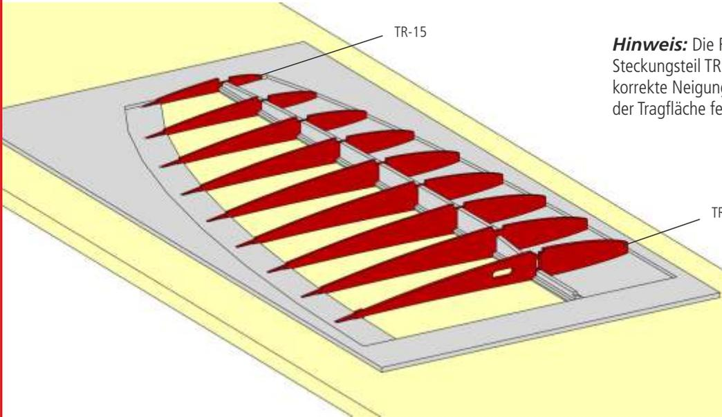
**Hinweis:** Die Rippe TR-06 wird erst später gemeinsam mit Steckungsteil TR-04 eingeklebt. Durch TR-04 wird die korrekte Neigung der Rippe entsprechend der V-Form der Tragfläche festgelegt.
