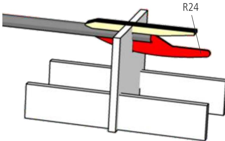
8 Rauen Sie das Kohlerohr im hinteren Bereich an und kleben Sie nun die geschliffene Leitwerksauflage auf das Rumpfrohr mit Hilfe der Schablone S10. Verwenden Sie Epoxyd-Harz. Die hintere schräge Kante ist ca. 1 cm vom Ende des Rumpfrohres entfernt.
