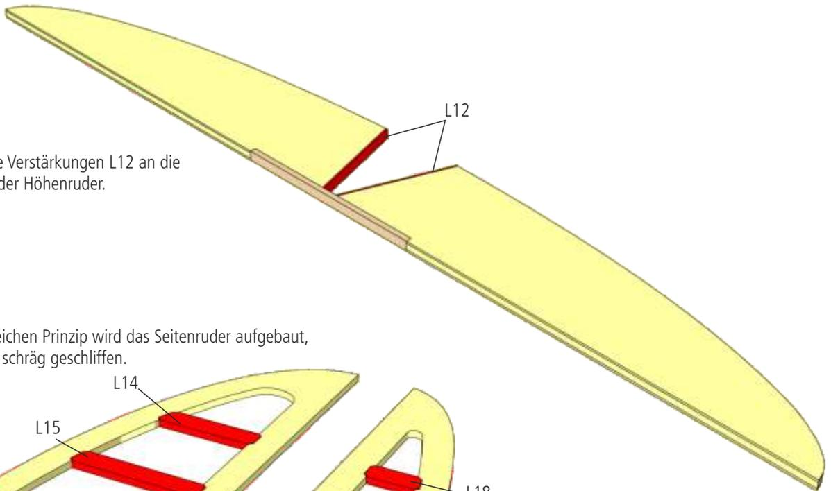
5 Nach dem gleichen Prinzip wird das Seitenruder aufgebaut, beplankt und schräg geschliffen.
