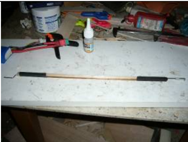
30. Zur Ansteuerung kann ein Stab wie abgebildet dienen. Z.b. aus 2x3mm Balsa (hart) mit Federdraht dazwischen. Die Anlenkung des HLW muß auf Druck und Zug stabil sein und darf sich nicht verformen.
