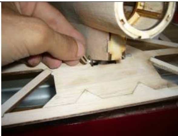
28. Um ein seitliches Verschieben zu verhindern, werden nun die großen Sperrholzringe eingesteckt, Diese werden nur mit dem Leitwerk (aussen) verklebt.
