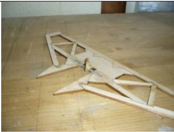
26. Als Drehachse dient ein 4mm Alustab an den ein Sperrholzruderhorn (2x1,5mm) mit angedicktem 5min. Epoxy angeklebt wird.
