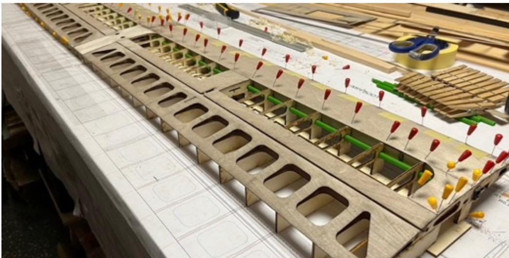
Schlussendlich folgen noch die Nasenleiste, Balsa 5x8mm, und die Deckrippen nach dem Einbau der Flächensicherung (HL).
