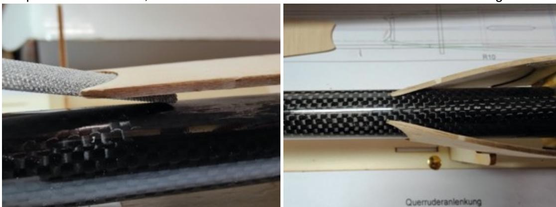
Der Rumpfboden, bestehend aus RB1, RB3, RB4 und RB5 wird über dem Bauplan ausgerichtet zusammengeklebt (HL).
