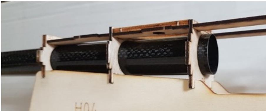
RSP1.2 (4mm Pappel) wird mit eingepresster M6 Mutter an die Unterseite von RSP1 und vor Spant S7 geklebt.
