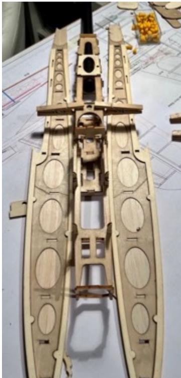
Die getrockneten Seitenwände werden anschließend seitlich auf die Spanten gesteckt. Eventuell die Ausnehmungen der Verzapfungen ein wenig nacharbeiten.
