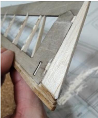
Nach dem Trocknen wird der untere Ruderabschluss mit 2x SR11 angeklebt (HL).
