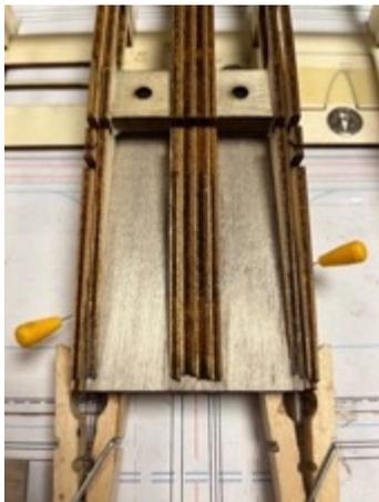
Zuerst wird nun die untere Centerbeplankung im Bereich der Rumpfaufgabe eingeschoben. *Eine genaue Ausrichtung mit den Löchern für die Schraubbefestigung sowie der seitliche Abschluss mit den Rippen ist Grundvoraussetzung für die spätere Passung der weiteren Beplankungsteile!*
