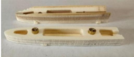
Die Inserts werden in den oberen Teil von innen eingepresst, und zusätzlich mit SK gesichert/verklebt.
