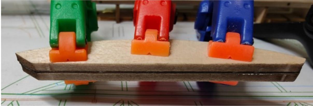
Nach dem Trocknen wird noch die Nasenleiste (Balsa 4x7mm) vorne angeklebt. Zuvor die Bepunktung und die Hilfsnasenleiste mit einer langen Schleifplatte bündig schleifen.
