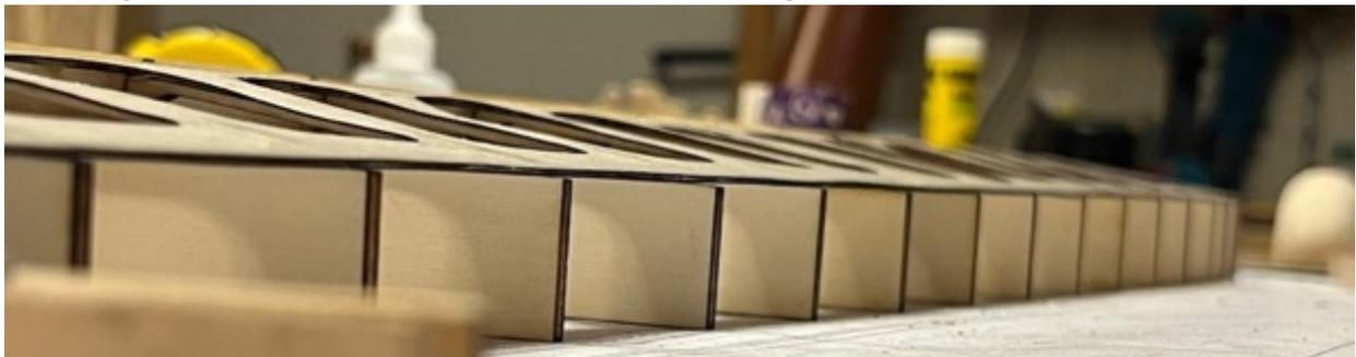
Weiter geht's an der Vorderseite mit dem Holmaufbau und der unteren Nasenbeplankung.
