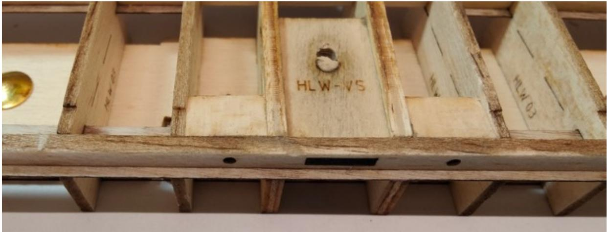
Der seitliche Randbogenabschluss folgt als Nächstes. Zuvor muss die Flucht noch plangeschliffen werden, um die Abschlussrippe HLW19 ankleben zu können.
