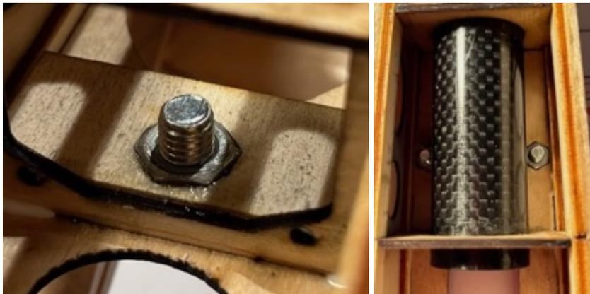
Zuvor noch den Übergang von der Seitenwand zum CFK-Rohr wird mit einer Rundraspel/Rundfeile entsprechend behandelt, damit sich die Seitenwand formschön an das Rohr schmiegt und kleben lässt.
