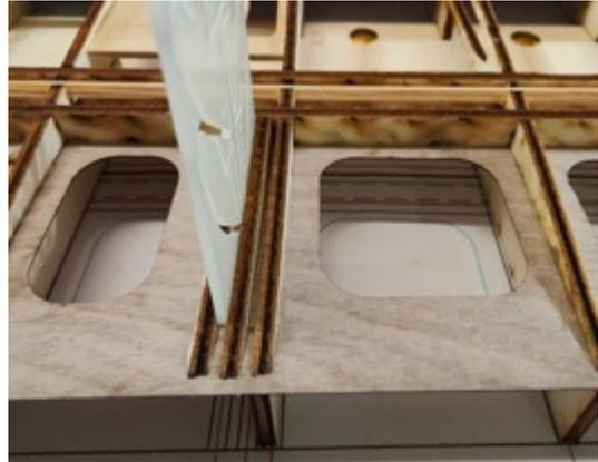
Den unteren Holmgurt in die Rippenausnehmung klipsen und mit den Rippen verkleben (SK oder HL). Den vorderen unteren Hilfsholm aus Kiefer 2x5mm ebenso (SK oder HL).
