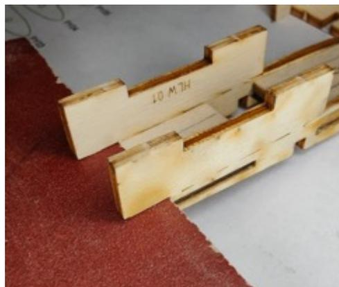
Dieser Block wird nun in die Schablone eingesetzt und der Rippenkamm vorsichtig von oben eingesetzt.
