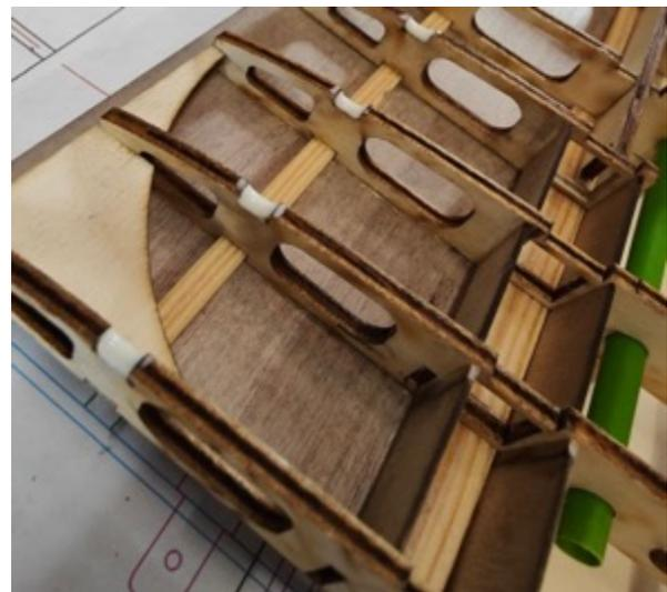
Das Steckungsrohr an der Rückseite wieder mit einem Holzreststück verschließen.
