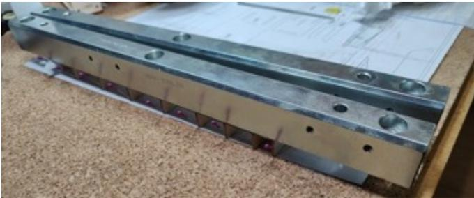
Anschließend wird SR20 und SR21 als Rudernasenleiste angeklebt. Die Ausrichtung erfolgt am besten über die Schlitze für die PVC-Scharniere.
