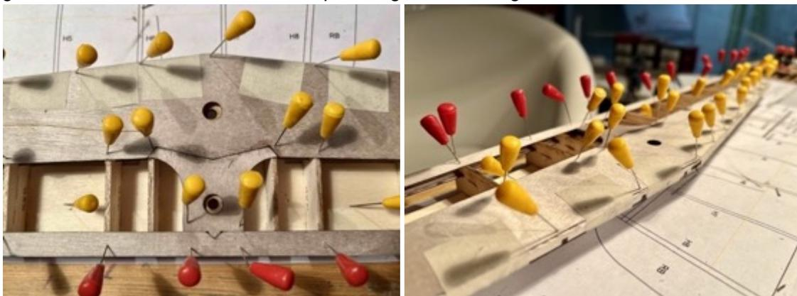
Der Randbogen besteht aus einem Sandwich Balsa-Sperrholz-Balsa und muss noch zusammengeklebt werden (HL), bevor dieser an seine endgültige Position geklebt werden kann.
