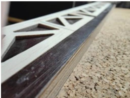
An der Rudernase wird wieder ein Keil hergestellt. Die Scharnierschlitz geben die Mittellinie vor. Als Scharnier werden hier die beiliegenden Vliesscharniere verwendet, welche mit Sekundenkleber in die vorbereiteten Schlitz gelehrt werden.
