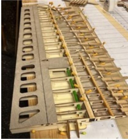
Nach dem Trocknen wird die Oberkante der Hilfsnasenleiste wieder mit der Rippenoberkante bündig geschliffen.
