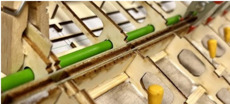
Nun wird die untere Beplankung an die Rippen und den Hilfsholmgurt geklebt.
