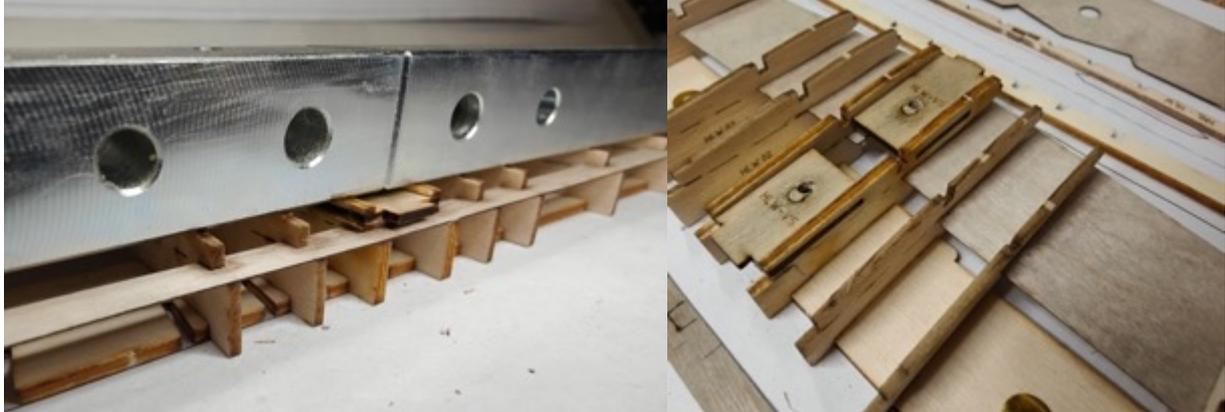
Nun wird der Rippenkamm nochmal herausgenommen und mit Leim eingeklebt und mit Gefühl an die unter Beplankung gepresst.
