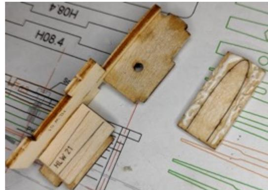
Bei HLW21 ist ein leichter Absatz für die Endleistenbeplankung herzustellen.
