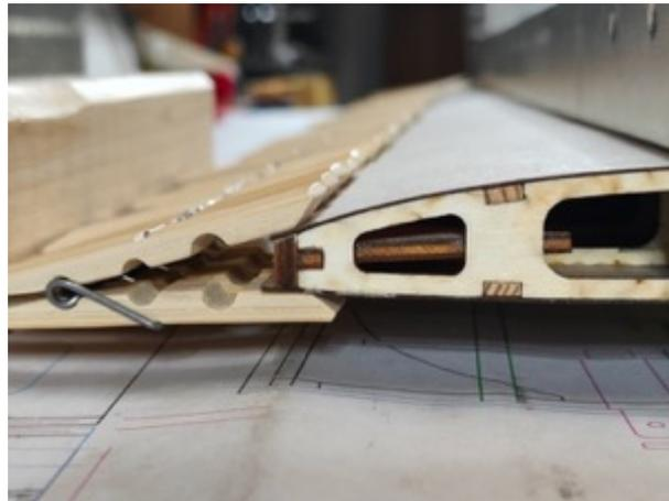
Nach dem trocknen wird die überstehende Beplankung mit der Hilfsnasenleiste bündig geschliffen. Anschließend wird die Nasenleiste, Balsa 5x8mm, und die beiden Randbogenteile angeklebt.
