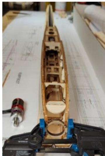
Der Spant S1 wird als Letzter in das ganze System eingebaut (HL oder Hz), wenn die anderen Klebestellen alle bereits gut getrocknet sind. Wenn erforderlich hier beherzt die gezeigten Plastikzwingen einsetzen. An der Rumpfaußenseite unbedingt ein Abfallholz dazwischen geben, damit die Zange keine Verdrückungen hinterlässt. Alle Klebestellen gut vermuffen.
