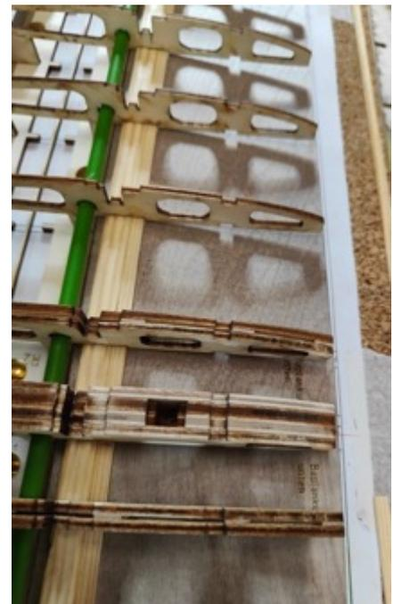
Sitzt alles richtig, wird jetzt der Holmgurt mit der unteren Beplankung verklebt. (SKm) Die Rippen werden erst nach dem Trocknen mit der Beplankung verklebt.
