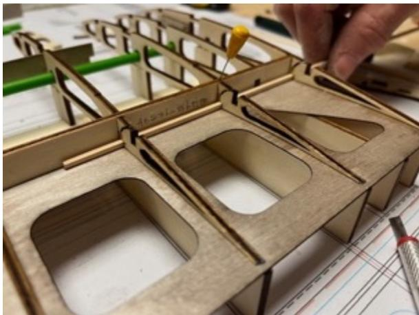
Die Leiste für die Wölbklappe folgt als Nächste. Von oben eingesetzt kann diese mit Leim eingeklebt werden.
