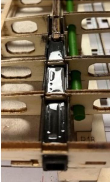
Das Steckungsrohr wird in die Rippenöffnungen eingeschoben und die Verkastung (H1-H4, V1-V4) aus 0,8mm Sperrholz eingebaut. Ein kleiner Spalt zum Steckungsrohr muss sein, damit das Harz auch unter das Steckungsrohr kriechen kann.
