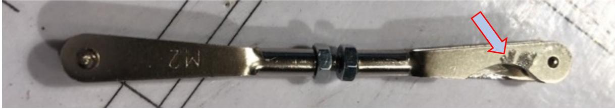
Eingehängt wird der Gabelkopf beim 2. oder 3. Loch am Servohebel.
