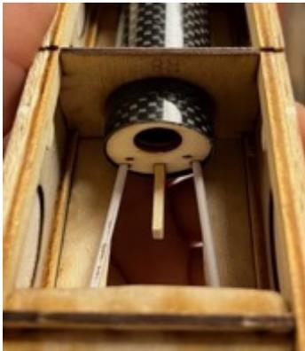
Nachdem dieses Konstrukt im Rohr untergebracht wurde, können die Rumpfspanten S8, S9 und S10 auf das Rohr aufgefädelt werden und wieder in die Helling gesteckt werden. Nach erneutem Ausrichten und Kontrollieren der Flucht, werden die Spanten miteinander verklebt (SK). Ebenso wird das CFK-Rohr mit den Spanten verklebt.
