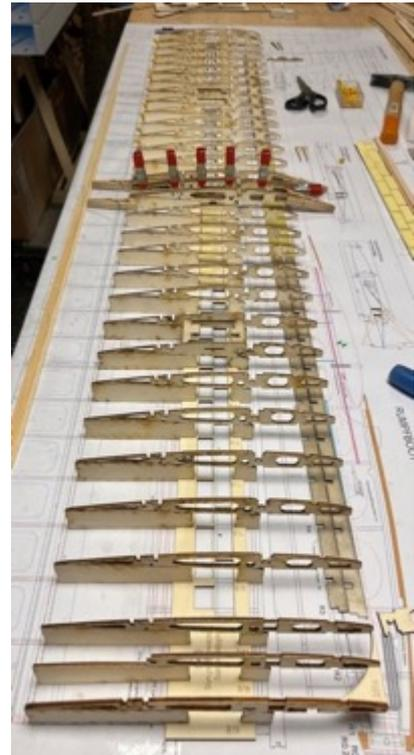
Nun wird die untere Ruderbeplankung in den Schlitz zwischen Fuß und Rippe von hinten, auf beiden Seiten, eingeschoben.
