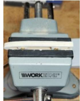
Der Ober- und Unterteil wird, ausgerichtet an deren Außenkontur, miteinander verklebt (HL). Danach diesen außenseitig etwas überschleifen, um die Haltestege vom Fräsen zu entfernen.
