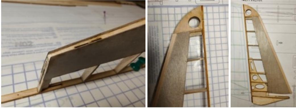
Die Balsaaufdoppelung SR9, in Rohrverlängerung, kann nun ebenfalls aufgeklebt werden.
