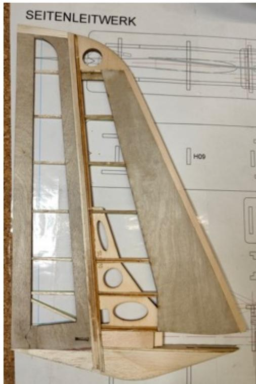
Das Seitenleitwerk ist nun rohbaufertig und kann mit Hilfe der Nasenschablonen geschliffen und für's Folieren vorbereitet werden.
