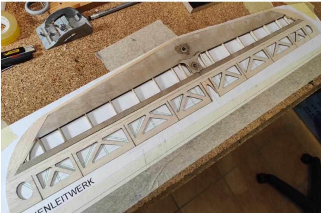
Das Höhenleitwerk kann nun unter Zuhilfenahme der Nasenschablonen feingeschliffen und anschließend bespannt werden.
