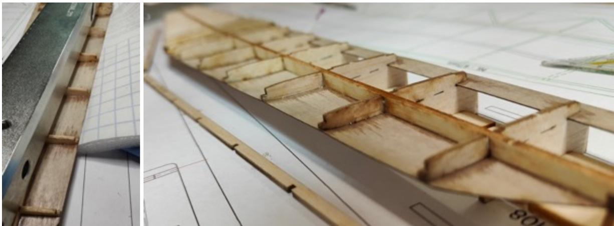
Anschließend werden die Hilfsnasenleiste (HNL-HLW) und die Abschlussleiste (HLW-EL) angeklebt.
