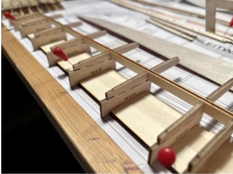
Der Rippenkamm, aus 3mm Pappel, dient hierbei als Ausrichthilfe.
