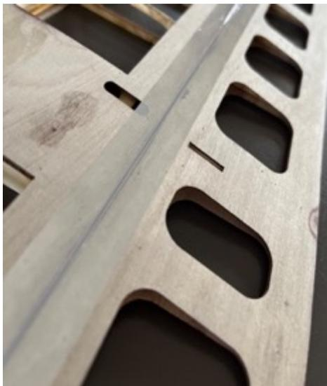
Im Besten Fall entsteht ein kleiner „Ruderspalt“ an der Rudernasenleiste wo sich die Folie vom **unten** aufgebügelt Folienstreifen mit der **oben** aufgebügelt Folie verklebt und so die Drehachse/Scharnierachse bildet.
