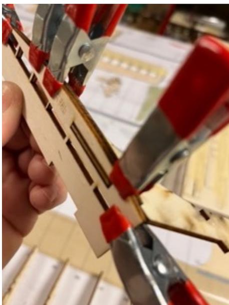
R38a und R38b zusammenkleben. Die Randbogenaussteifung aus 3mm Pappel als Ausrichthilfe verwenden.
