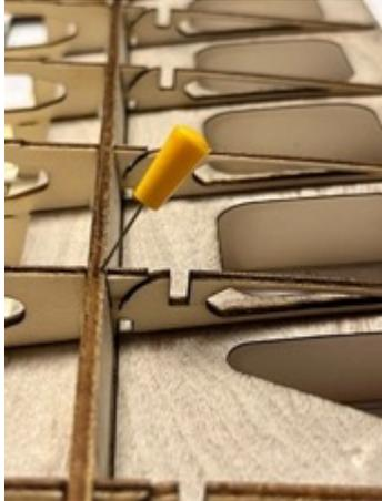
Nachdem diese genau ausgerichtet wurde (der Laserschnitt am Ruderanfang muss mit der Abschlussleiste in einer Flucht liegen) und ohne Spannung in den Schlitz sitzt, wird sie mit Sekundenkleber mit den Rippen verklebt.
