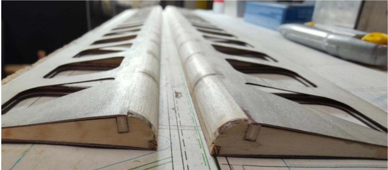
Die Nasenleiste der Fläche kann auch bereits geschliffen werden. Die Kontur bitte mit den beiliegenden Schablonen immer wieder kontrollieren. Je genauer die Nase ausgebildet ist, umso besser wird das Modell schlussendlich fliegen und seine Leistung bringen.
