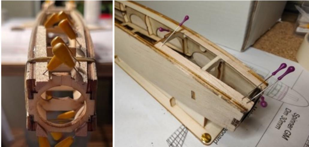
Bevor nun der Rumpfboden aufgeklebt wird, sind die Muttern nochmal gut zu verkleben (SK).
