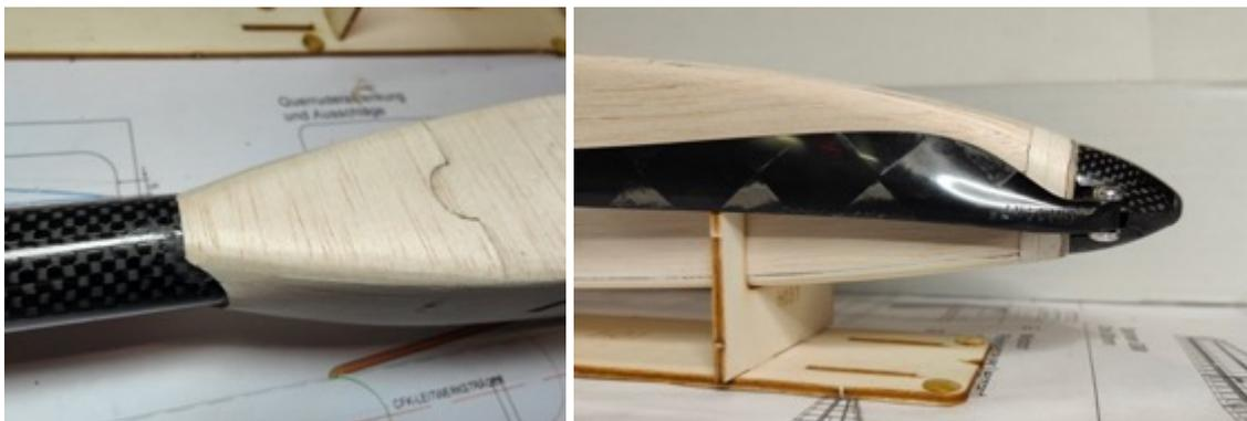
Nun kann das Seitenleitwerk mit dem CFK-Rohr fixiert werden. Das Seitenleitwerk hinten auf das Rohr schieben und alles zusammen in die Helling legen. Es sollte sich alles von selbst ausrichten. Die Leitwerksflosse wird in H10 fixiert. Das CFK-Rohr liegt in H5 und H8 auf, das Rumpfbboot liegt satt im vorderen Teil der Helling.
