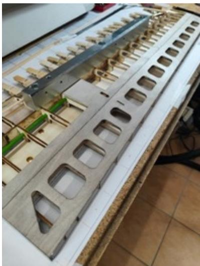
Als nächster Schritt werden die obere Ruderbeplankung und die Endleistenbeplankung aufgeklebt. Zuvor die eingeklebten Leisten mit den Rippen oberflächenbündig schleifen.
