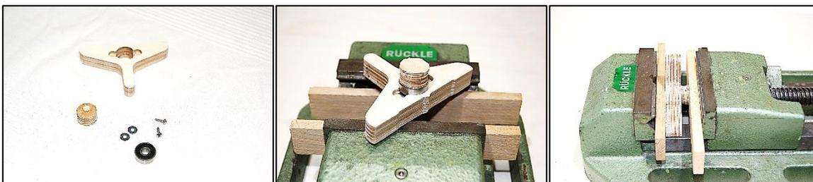
5. Anschließend wird das Lager noch mit den M3 Scheiben und den Blechschrauben gesichert. Hierzu einfach die Scheiben neben das Lager legen und die Schrauben ohne vorzubohren mit etwas druck einschrauben. Anschließend die Gummiauflagen wie abgebildet aufkleben. Zum Schluss noch mit einem Permanent Marker die Erhebung für die Anzeige des Schwerpunktes nachzeichnen.
