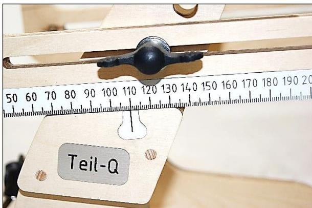
2. Bringen sie die Wippe in die vordere Anschlagposition. Jetzt hat sie genau 10° Auslenkung. In dieser Position kann der Anschlag als Einstellung genutzt werden.
