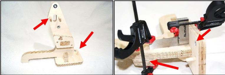
7. Anschließend können die Wippen montiert werden. Hierzu die M6x30 Schrauben auf der Seite der Lagerfixierung einstecken und auf der anderen Seite 4 kleine M6 Scheiben und abschließend eine große M6 Scheibe aufstecken. Das Ganze dann an das Grundgestell wie dargestellt anschrauben.
