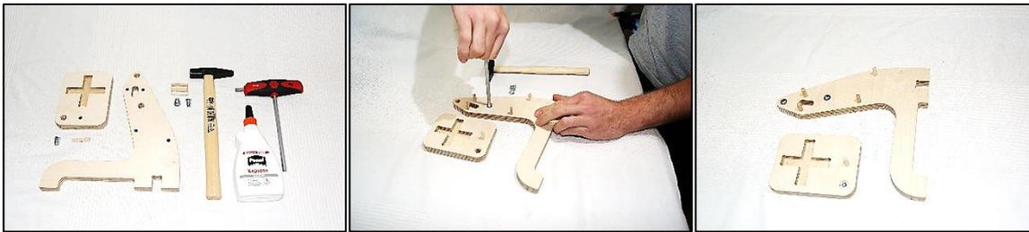
3. Jetzt kann das gezeigte Bauteil an das Grundgestell geklebt werden. Hierzu etwas Kleber auftragen und auf die vorher eingesetzten Holzdübel aufsetzen. Das Ganze dann mit Schraubzwingen sichern bis der Kleber ausgehärtet ist.
