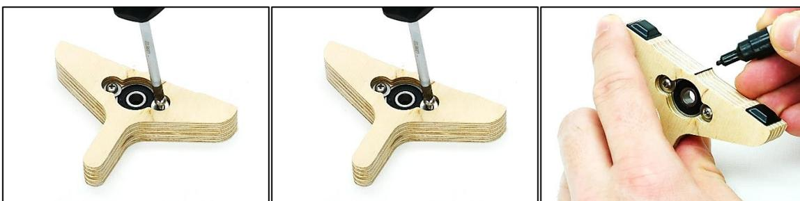
6. Jetzt können die Überstände der Verstiftung vom Grundgestell abgeschliffen und das Grundgestell verklebt werden. Hierzu alle Flächen der Steckung dünn mit Holzleim einstreichen und alles zusammenstecken. Hierbei auf die richtige Grundplatte wie in der Abbildung mit den Pfeilen dargestellt achten (Das Einschraubgewinde in der Grundplatte ist auf der Gegenseite der Holzdübel). Alles mit einem Anschlagwinkel und Schraubzwingen fixieren und austrocknen lassen.
