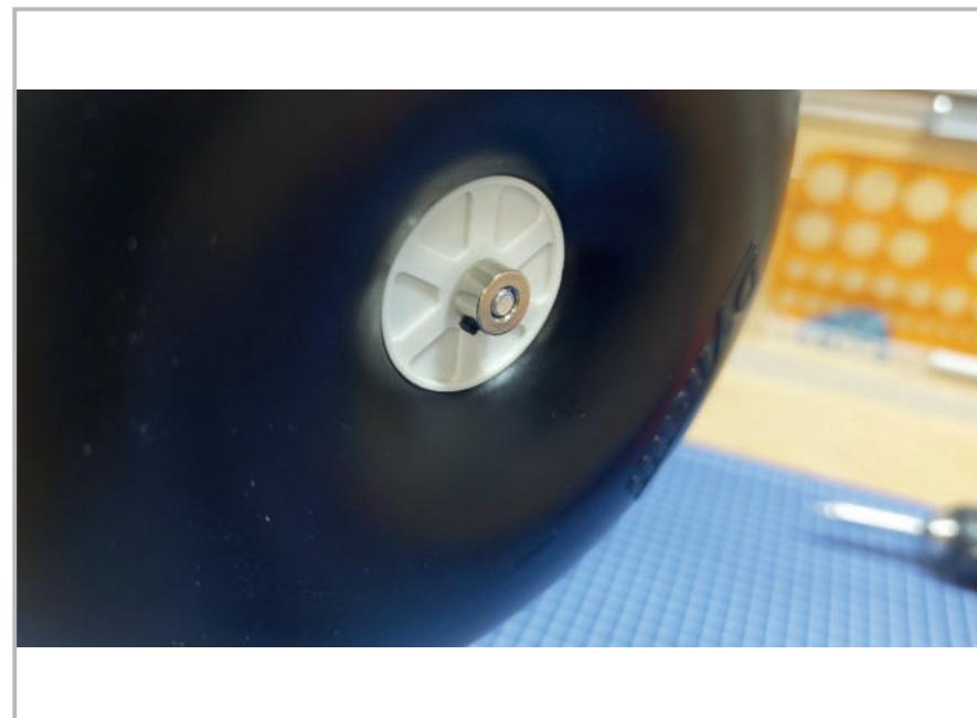
Die Radachse (M4x35mm) wird mit Stoppmutter versehen und nimmt das Rad auf. Abschließend fixiert ein 4mm Stellring das Rad am Fahrwerk.
