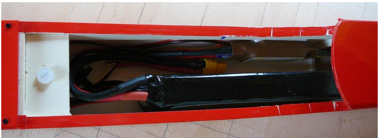
Einbau Akku und Regler, den Empfänger möglichst nach hinten legen.
