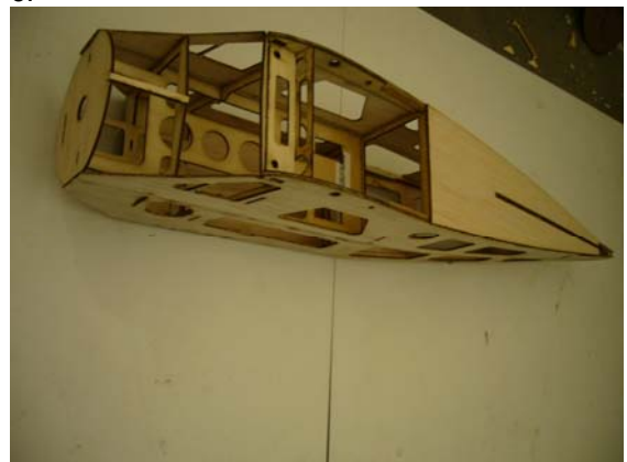
Rumpfoberteil ankleben. Zur besseren Befestigung des Seitenleitwerks auf der Innenseite des Spalts zwei Balsaleisten anbringen
