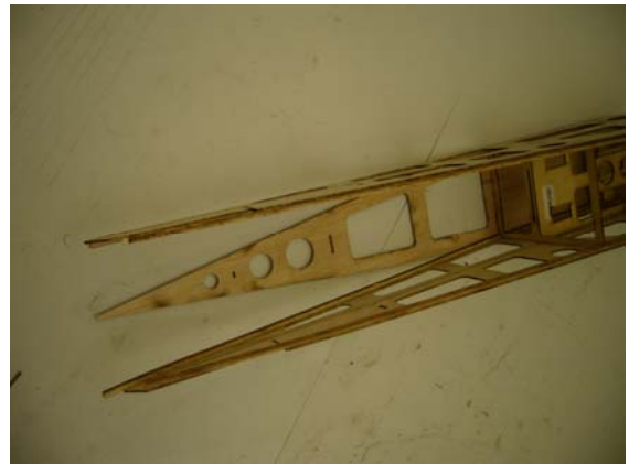
Unterteil ankleben, die Rumpfseiten zusammenziehen und verkleben
