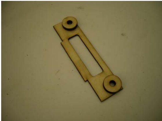
2x Sperrholzringe re./li. an der Flächenbefestigung und je 1x am Fahrwerksbrettchen zur Aufnahme der Einschlagmuttern aufdoppeln.
